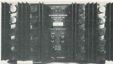
*Il gruppo dei finali. Ogni canale impiega 4+4 transistor di potenza NPN, pilotati da altri due collegati ad emitter follower.*
